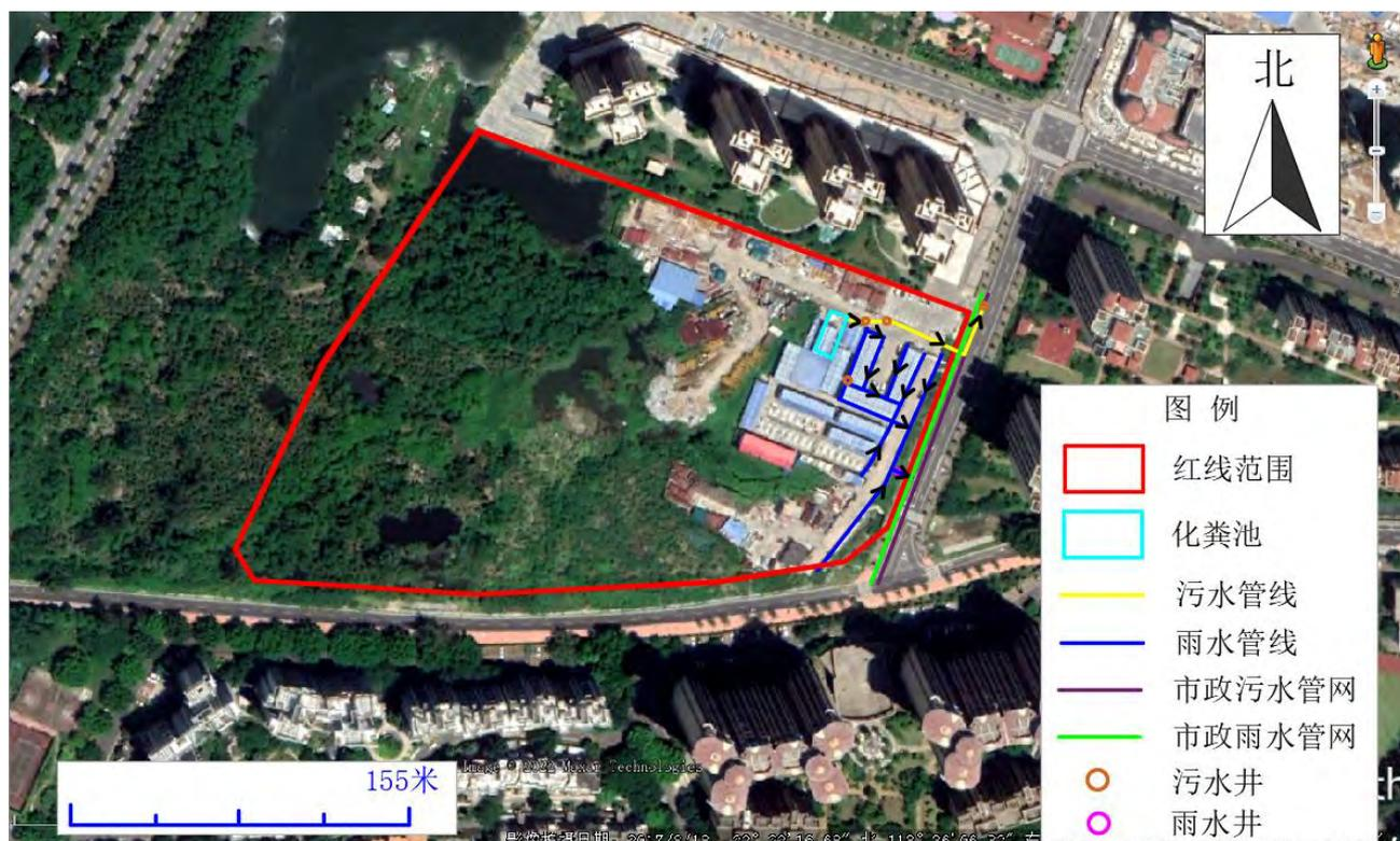
图 3.11-5 地块内雨水、污水管线分布
